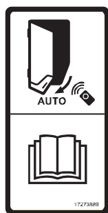
37 WAARSCHUWING! Deuropening met afstandsbediening, valgevaar (extra) Onderdeelnummer reserveonderdeel in VS: 17309879 Onderdeelnummer, alle overige markten: 17273889
