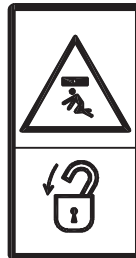
16 WAARSCHUWING! Vergrendel de voorruit. WAARSCHUWING! Veiligheidsblokkering activeren alvorens de gevarezone te betreden.
