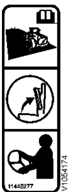
27 Gebruik joystickbesturing (CDC) op de openbare weg verboden – stuurwiel gebruiken. Onderdeelnummer: 11445277
