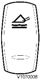
Schakelaar, enkelwerkende heffunctie activeren
