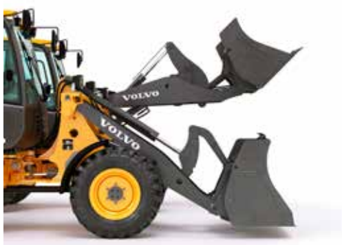
Val mellan parallell- eller Z-länksystem (L25 Electric)
