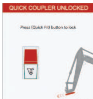
Snelkoppelingsschakelaar voor aanbouwdelen (snelkoppelingsknop)
