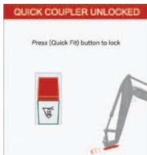
Schakelaar voor snelkoppeling, rechts
