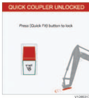
Snelkoppelingsschakelaar voor aanbouwdelen (snelkoppelingsknop)
