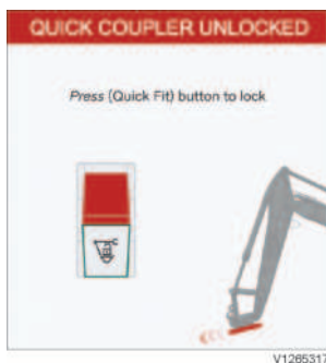
Snelkoppelingsschakelaar voor aanbouwdelen (snelkoppelingsknop)
