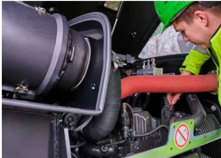
Ruime toegang tot de motorruimte met slechts één handgreep. De zijplaat van de motorgondel kan ook worden geopend.
